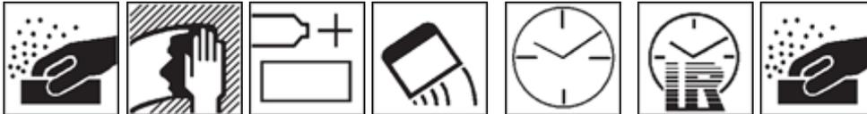
отшлифовать    обезжирить    время нанесения 4 мин/20°C    наносить шпателем    20-30 мин/23°C    5-8 мин    P80-P120
